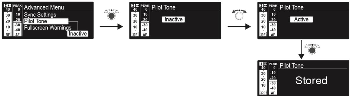
Der Pilotton hat eine nicht hörbare Frequenz, die vom Sender übertragen und vom Empfänger ausgewertet wird. Er unterstützt die Rauschsperrfunktion (Squelch) des Empfängers.
