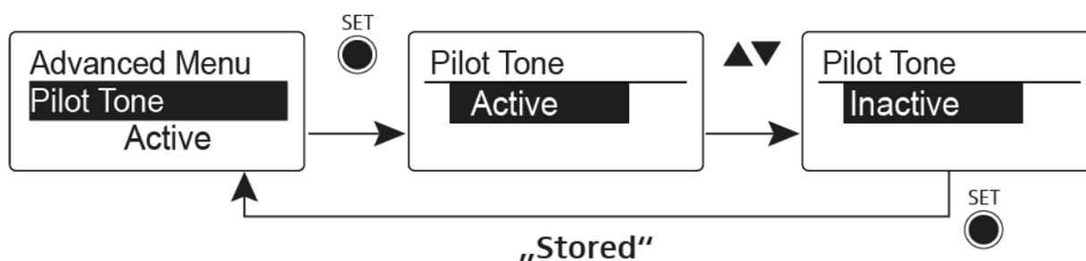
Der Pilotton hat eine nicht hörbare Frequenz, die vom Sender übertragen und vom Empfänger ausgewertet wird. Er unterstützt die Rauschsperrfunktion (Squelch) des Empfängers.
