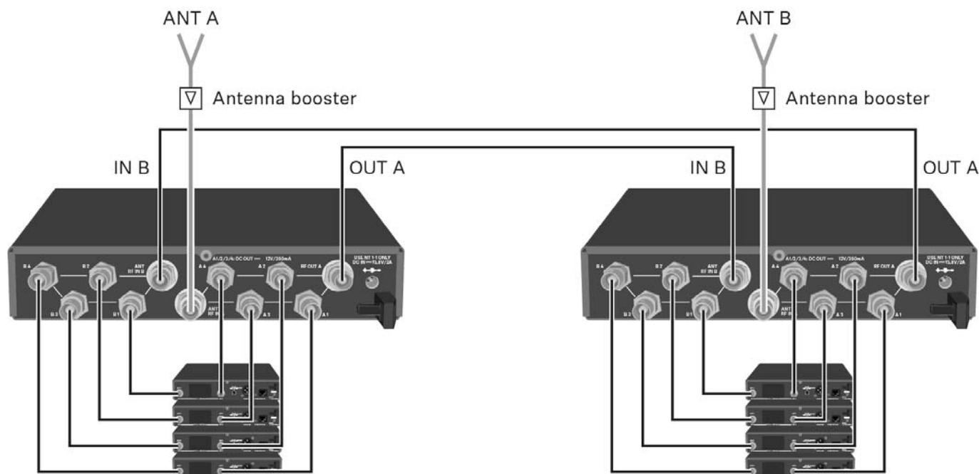
Option 3: Zwei Antennen versorgen eine 8-Kanal-Anlage
