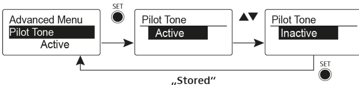
Der Pilotton hat eine nicht hörbare Frequenz, die vom Sender übertragen und vom Empfänger ausgewertet wird. Er unterstützt die Rauschsperrfunktion (Squelch) des Empfängers.
