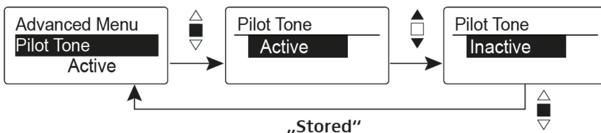
Der Pilotton hat eine nicht hörbare Frequenz, die vom Sender übertragen und vom Empfänger ausgewertet wird. Er unterstützt die Rauschsperrfunktion (Squelch) des Empfängers.
