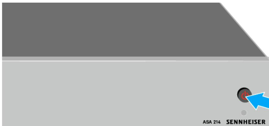
Um den Antennen-Splitter in **Standby** zu schalten:
